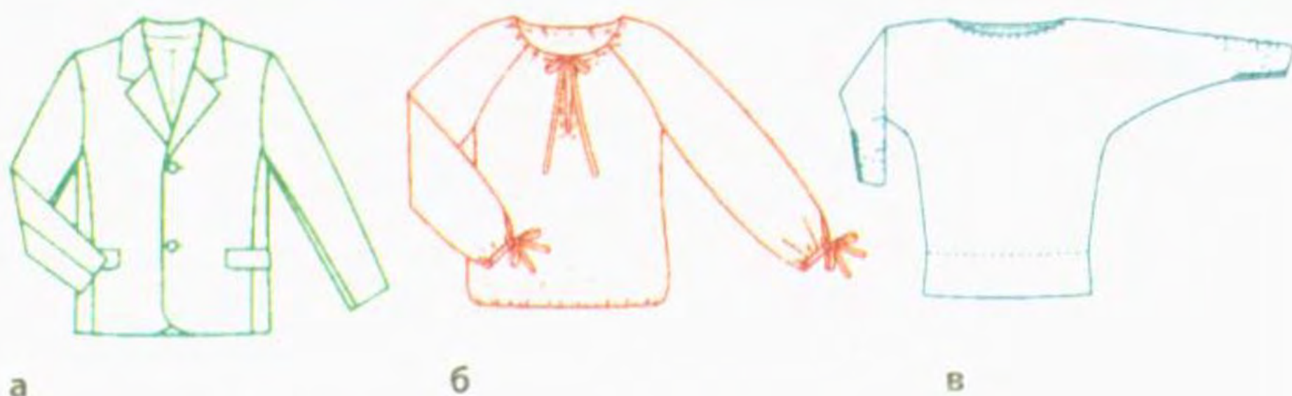
Рис. 1.7. Види рукавів за кроєм: а — вшивний; б — реглан; в — суцільнокрійний (кімоно)
