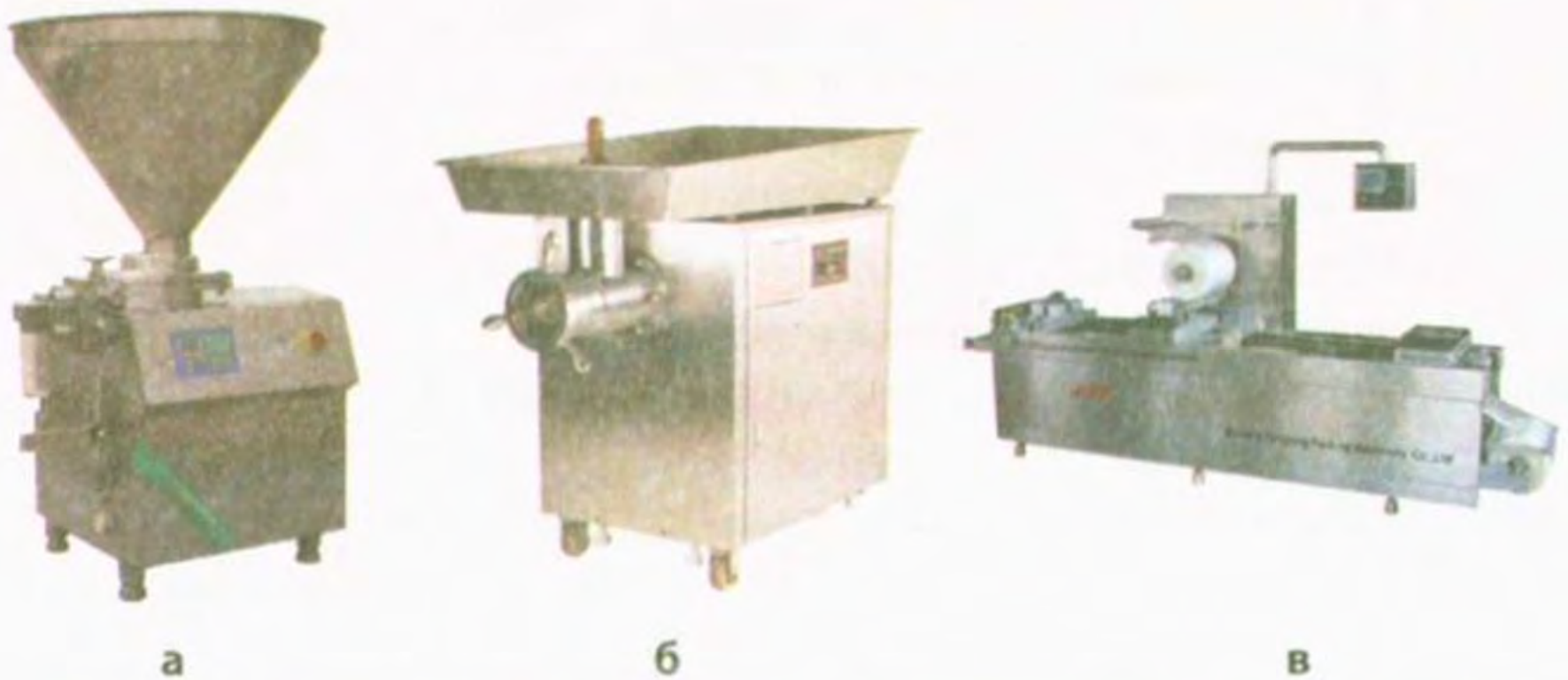
Рис. 4.5. Обладнання, яке застосовується на м'ясокомбінатах: а — вакуум-шприц для наповнення ковбас; б — промислова м'ясорубка; в — термоформувочні лінії для вакуумної упаковки м'ясних виробів
