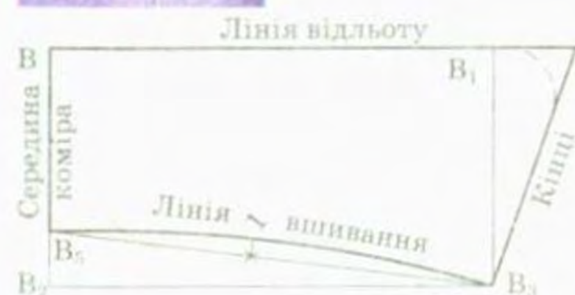
Рис. 1.17. Креслення відкладного коміра для виробів із застібкою доверху
