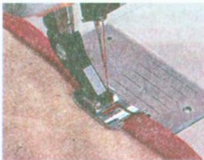
Рис. 2.6. Лапка для пришивання канта
