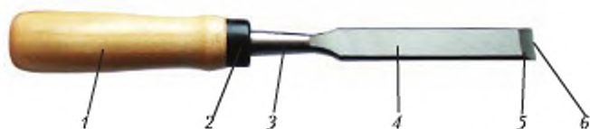
Рис. 68. Стамеска: 1 – ручка; 2 – кільце; 3 – шийка; 4 – різець; 5 – фаска; 6 – різальна крайка
