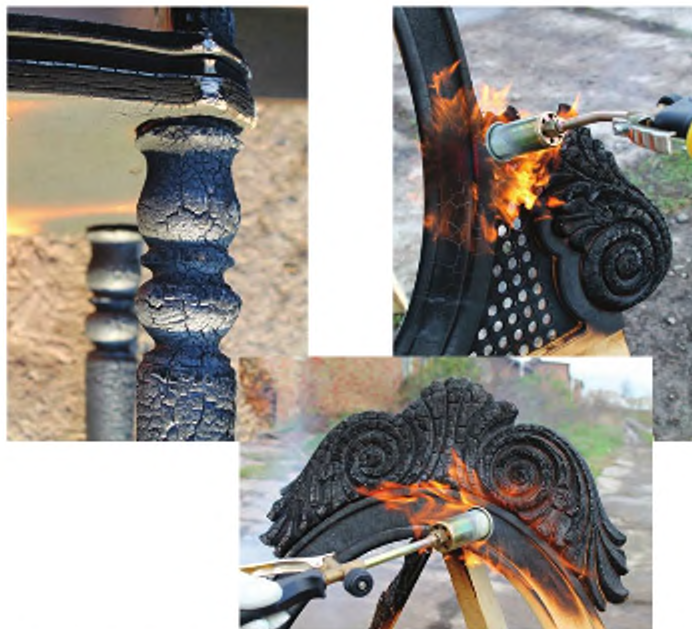
Рис. 82. Обпалювання дерев'яного каркасу меблів
