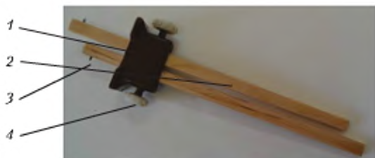
Рис. 41. Будова рейсмуса: 1 – колодка, 2 – брус, 3 – шпильки, 4 – затискні гвинти (або клин)
