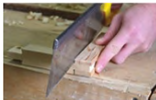
Рис. 72. Припасування шпипового з'єднання ножівкою
