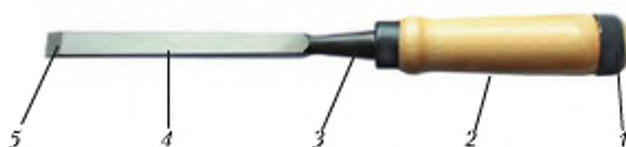
Рис. 67. Долото: 1 – кільце; 2 – ручка; 3 – шийка; 4 – різець; 5 – фаска
