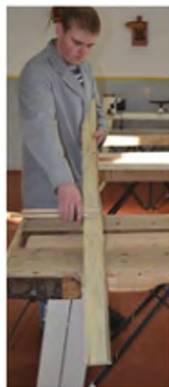
Рис. 44. Розмічання рейсмусом для стругання крайки
