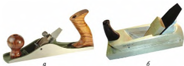
Рис. 52. Інструменти для стругання деревини: а – рубанок; б – шерхбель
