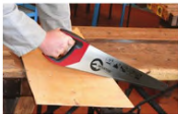
Рис. 49. Нахил ножівки: a – під час пиляння фанери; б – під час пиляння деревини
