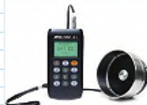
Рис. 17. Пристрої для вимірювання вологості деревини у промислових умовах
