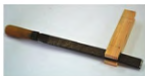
Рис. 71. Припасування вухка (гнізда) рапнілем
