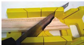
Рис. 50. Стусло: a – види стусел; б – пиляння за допомогою стусла
