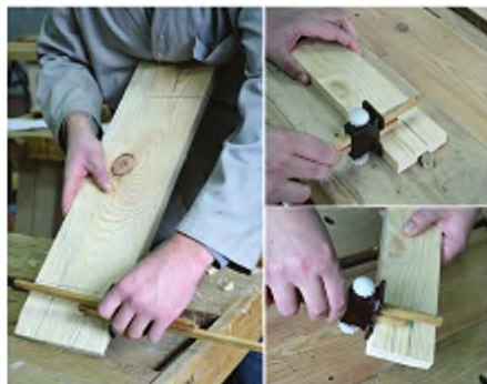
Рис. 66. Прийоми розмічання шипового з'єднання рейсмусом
