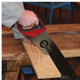
Рис. 49. Нахил ножівки: a – під час пиляння фанери; б – під час пиляння деревини
