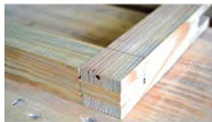
Рис. 73. Загальний вигляд готового шпипового кутового з'єднання
