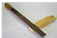
Рис. 71. Припасування вухка (гнізда) рапнілем
