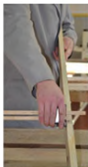
Рис. 43. Розмічання рейсмусом для стругання пласти
