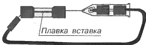
Мал. 135. Перевірка справності плавкої вставки електрозапобіжника
