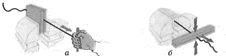
Мал. 105. Вирівнювання дроту за допомогою дерев'яних брусків: а – протягування дроту; б – переміщення брусків
