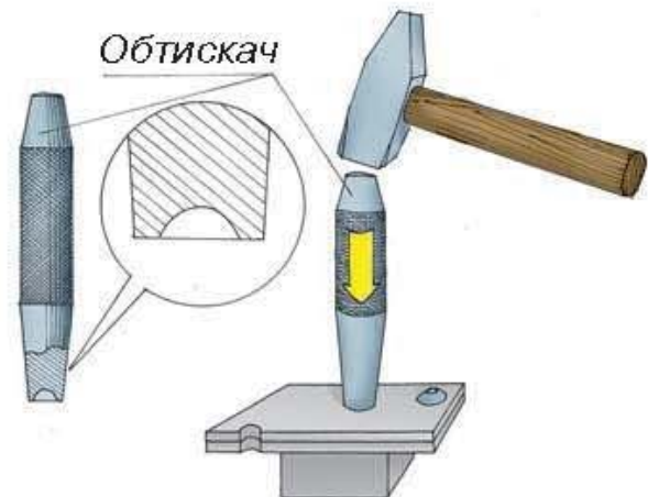
Мал. 117. Остаточне формування замикальної головки заклепки обтискачем
