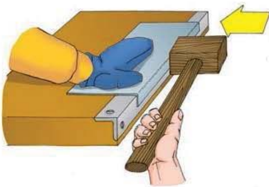
Мал. 108. Згинання країв заготовки для фальцювання
