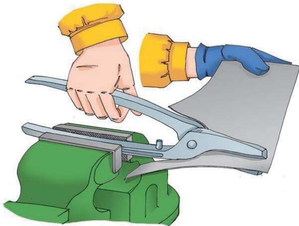
Мал. 75. Робота ножицями, закріпленими в лещатах
