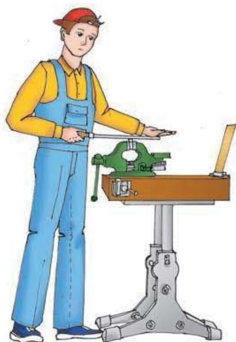
Мал. 83. Положення корпусу під час обпилювання деталі
