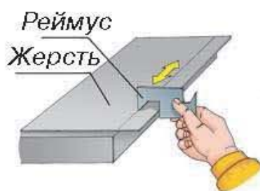
Мал. 118. Розмічання відгинів фальцювання рейсмусом
