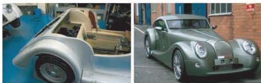
Мал. 91. Зліва — дерев'яний каркас та металеві панелі кузова; справа — готовий автомобіль
