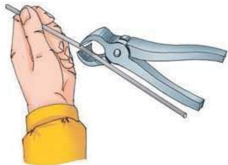
Мал. 130. Прийом різання дроту монтажними кусачками
