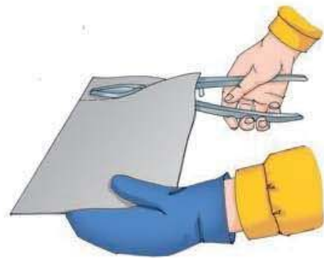
Мал. 74. Хватка ножиць при різанні тонколистового металу
