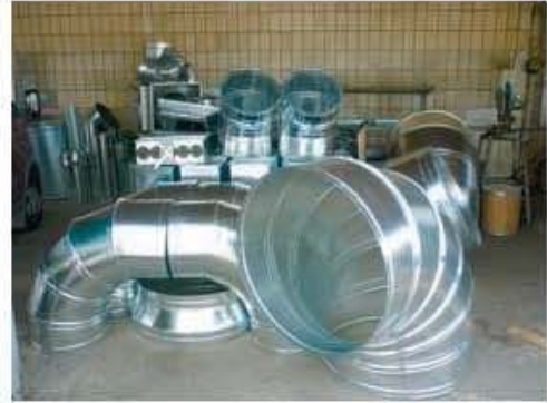
Мал. 101. Елементи промислової вентиляції з використанням фальцових швів
