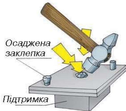
Мал. 116. Попереднє формування замикальної головки за допомогою слюсарного молотка
