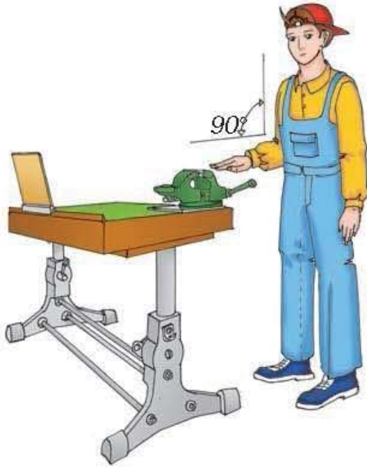
Мал. 11. Перевірка правильності вибору висоти слюсарного верстака
