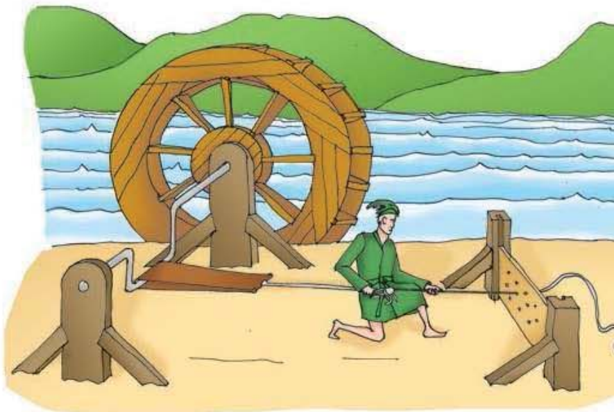
Мал. 30. Використання водяного колеса у виробництві дроту
