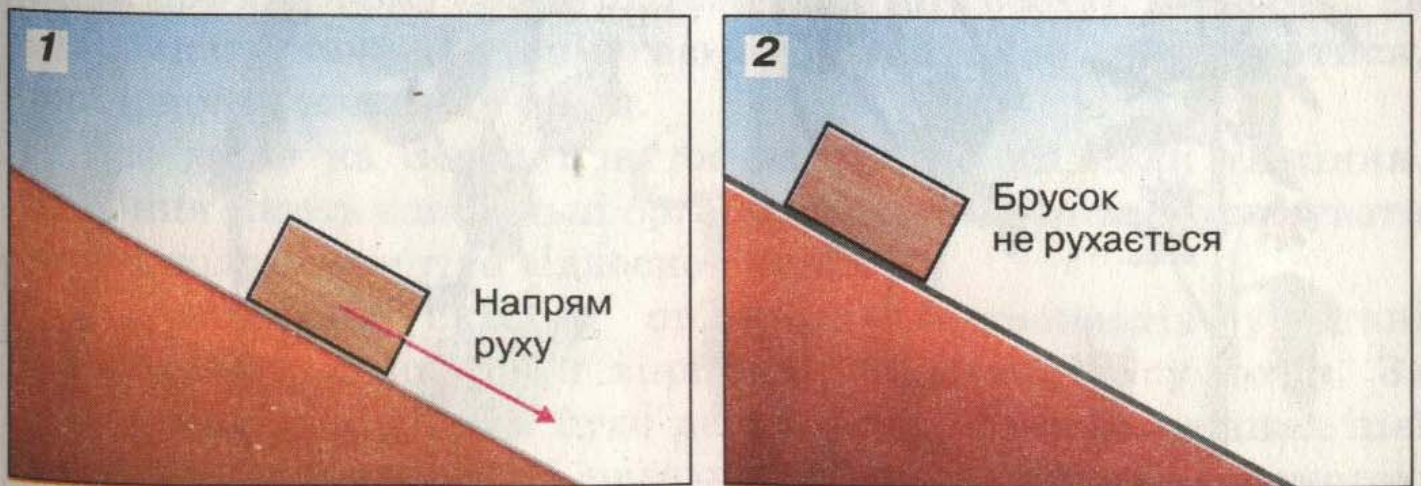
Мал. 86. 1 — рух бруска по похилій площині під дією сил земного тяжіння і тертя; 2 — сила тертя залежить від властивостей поверхні тіл, що труться
