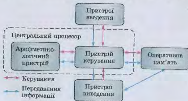
Рис. 3.9. Структура комп'ютера за фон Нейманом
