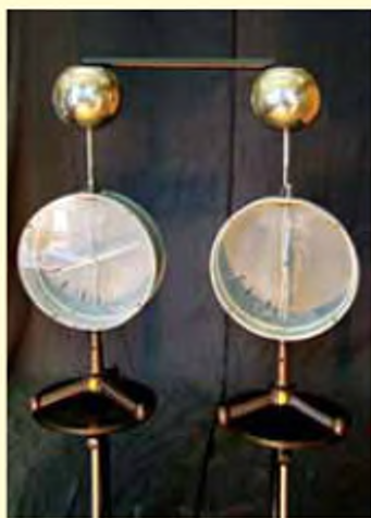
Рис. 92 б. Стрілка другого електрометра залищиться нерухомою
