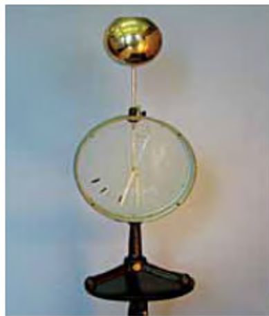
Рис. 88. Більш складний електроскоп-електрометр
