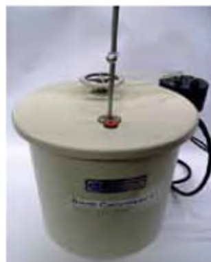
Рис. 60. Калориметр – прилад для вимірювання кількості теплоти, що виділяється і поглинається у процесі теплообміну: а) схема будови калориметра; б) калориметр у розрізі; в) лабораторний калориметр
