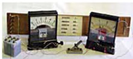
Рис. 129. Установка для визначення залежності опору провідника від його характеристик.
