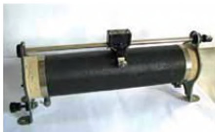
Рис. 130. Повзунковий реостат з ковзаючим контактом
