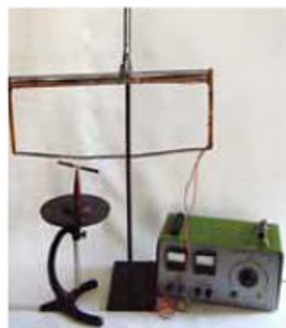
Рис. 106, а. Магнітна стрілка відхиляється від початкового положення, коли над нею (або поруч) по провіднику проходить електричний струм
