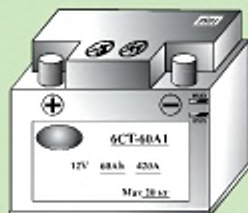
Рис. 120. Акумулятор, який складається з трьох елементів
