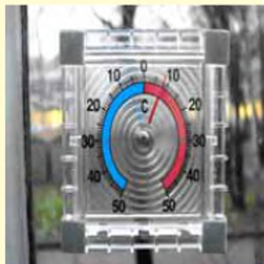
Рис. 15. Біметалічний вуличний термометр
