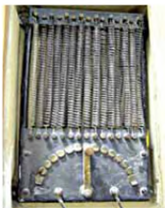
Рис. 131. Реостат у вигляді резистора
