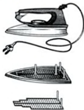
Рис. 150. Конструкція нагрівального елемента (ніхромова стрічка)
