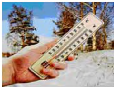
Рис. 9. Термометр, призначений для одночасного вимірювання температур за шкалою Цельсія і шкалою Фаренгейта
