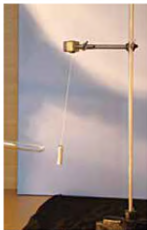
Рис. 84 б. Циліндрик притягується до палички
