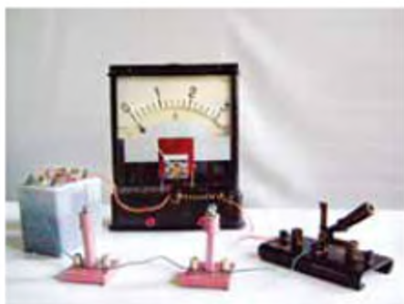
Рис. 137. Коло послідовного з'єднання двох електричних ламп та амперметра
