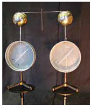
Рис. 89 а. Заряджений електрометр 1 з'єднали за допомогою металевої палички, закріпленої на пластмасовій ручці, з таким самим електрометром 2
