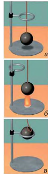
Рис. 32. Температурна залежність розміру фізичного тіла
