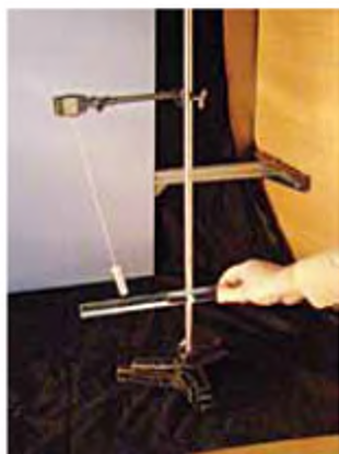
Рис. 95. Циліндрок відхиляється від свого початкового положення і буде притягуватися до палички
