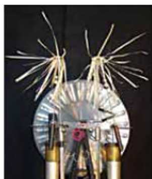
Рис. 100, б. Два султани, заряджені по чергово однойменними (позитивними) зарядами.
