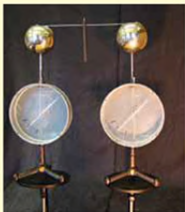
Рис. 92 а. Стрілки обох електрометрів відхилились на однакові кути
