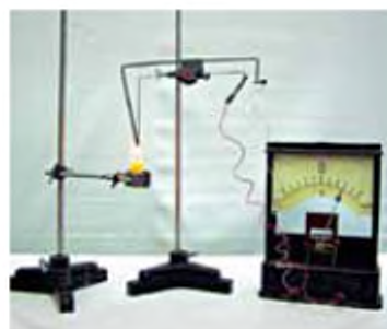
Рис. 116. Виникнення електричного струму в спаяних дротинах, виготовлених із різних металів і нагрітих в місці спаю.
