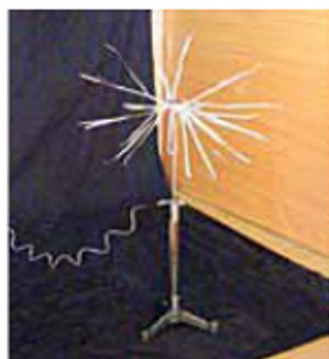
Рис. 98. Картина ліній напруженості електричного поля, створеного одним зарядом
