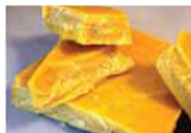
Рис. 27. Аморфні тіла: а) аморфні тіла навіть у твердому стані не мають періодичності у розташуванні атомів; б) смола; в) віск; г) пластмаси
