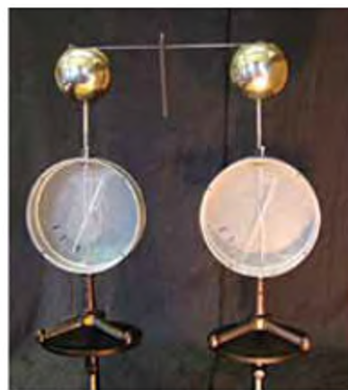
Рис. 89 б. Приєднавши другий електрометр до першого, на якому залишилась половина початкового заряду, побачимо, що стрілки обох електрометрів знову відхилились на однакові, але вже менші кути
