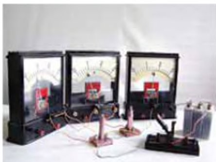
Рис. 143. Паралельне з'єднання двох електричних ламп
