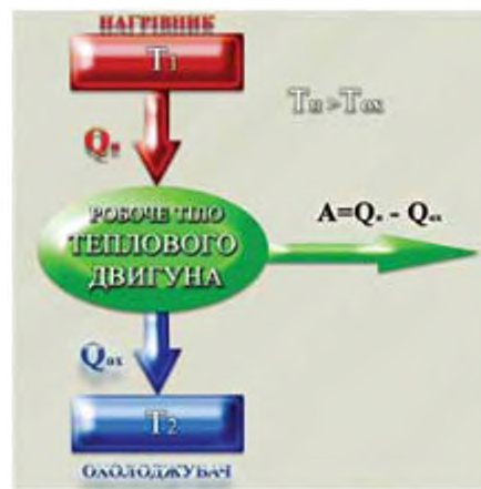
Рис. 73. Принцип дії теплового двигуна: робоче тіло отримує енергію від нагрівника, здійснює роботу і повертається у вихідний стан, віддаючи деяку кількість теплоти у холодильник
