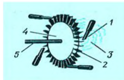
Рис. 80, б. Будова та принцип дії парової турбіни
