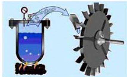
Рис. 80, а. Модель дії турбіни: енергія палива перетворюється на механічний (обертальний) рух колеса
