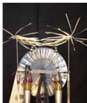
Рис. 100, а. Два султани, заряджені по чергово різнойменними зарядами.
