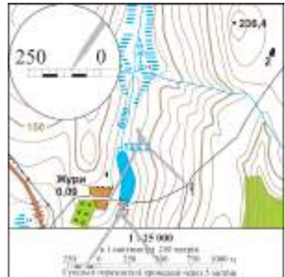
Мал. 37. Вимірювання відстаней за лінійним масштабом
