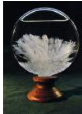
Мал. 98. Барометр Фіцроя (закрита посудина з розчином нашатирного спирту, камфорі, калійної селітри)
