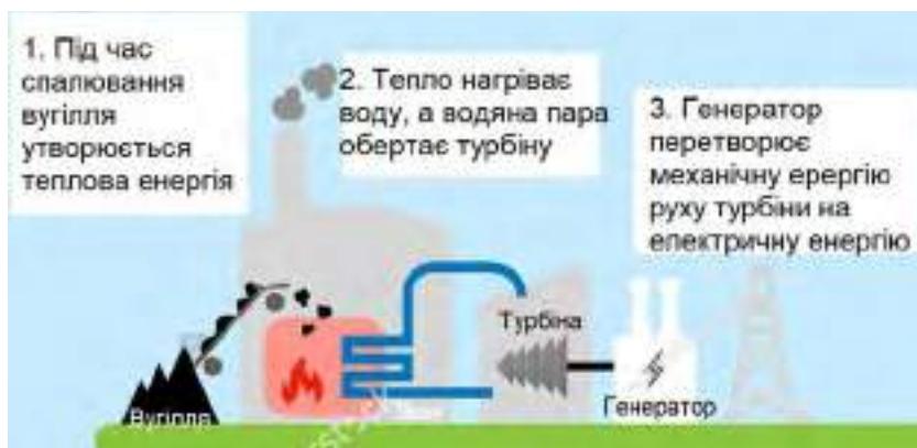
Мал. 74.2. Перетворення енергії спалювання вугілля на електричну
