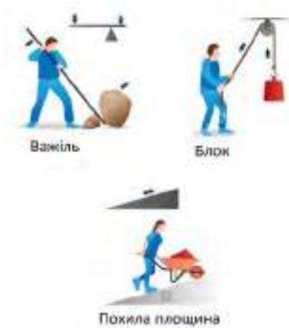
Мал. 75.1. Важіль та похила площина дають вигреш у силі, а блок дозволяє змінити напрямок дії сили на зручній
