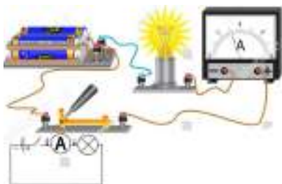
Мал. 67.1. Щоб виміряти силу струму в лампочці, амперметр приєднують до неї послідовно
