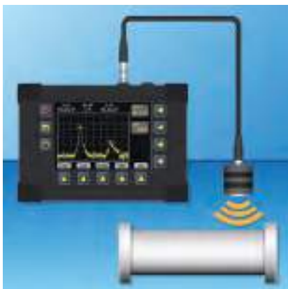
Мал. 60.3. Ультразвук допомагає виявляти дефекти всередині деталей
