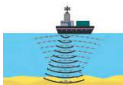
Мал. 60.2. Сонар дозволяє визначити глибину моря
