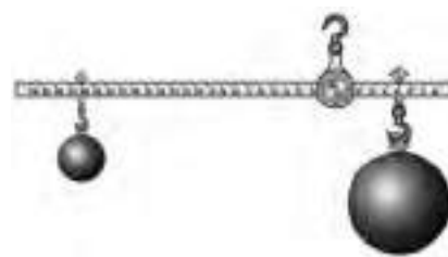
Мал. 37.7. Тіло меншої маси на важелі може врівноважити тіло більшої маси, якщо буде розташоване на більшій відстані від точки опори
