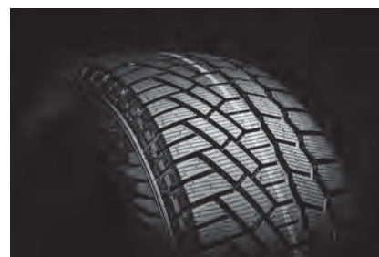
Мал. 29.6. Поверхню автомобільних шин роблять такою, щоб вона якнайсильніше «чіплялася» за поверхню дороги. Зітертий протектор шини може створити небезпеку під час руху. Сучасні шини оснащують спеціальними «маячками» — кольоровими стрічками в середині протектора, які стають видимими в разі граничного зносу шин
