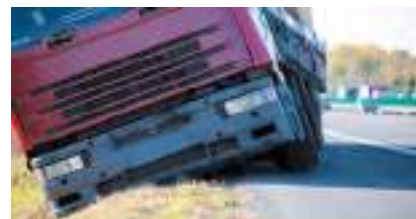
Мал. 54.2. Якщо правими чи лівими колесами машина потрапить на м'який ґрунт на узбіччі, машину розвертає в бік узбіччя
