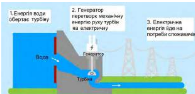
Мал. 74.1. Перетворення енергії руху води на електричну енергію
