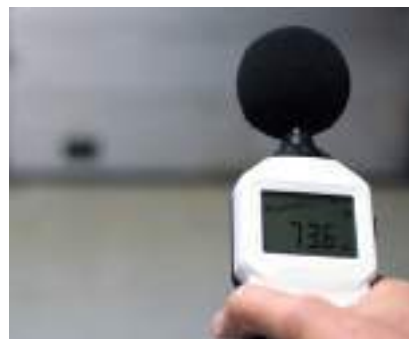
Мал. 59.2. Шумомір — спеціальний прилад для вимірювання рівня шуму
