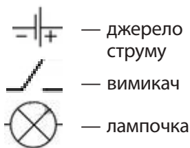
Мал. 66.2. Умовні позначення деяких елементів електричного кола
