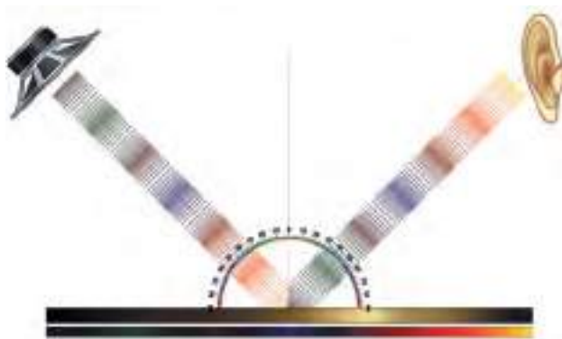
Мал. 58.2. Звук відбивається від пласкої твердої поверхні так само, як світло від дзеркала
