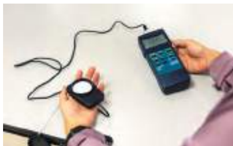
Мал. 51.3. Люксметр дозволяє виміряти освітленість будь-якої поверхні
