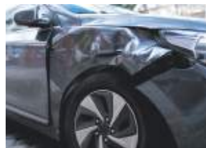
Мал. 26.8. Унаслідок зіткнення з іншим автомобілем крило машини зазнало значних пластичних деформацій
