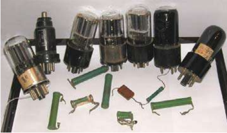
Деталі «Малої електронної обчислювальної машини»: електронні лампи, опори, конденсатори
